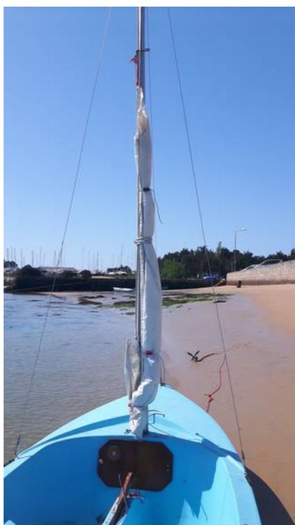
J'ai dû aussi rajouter un petit bout (en rouge sur la photo) et un taquet bloqueur pour empêcher le moteur de remonter lorsque celui-ci est éteint, à la voile. Il faut bien penser à l'enlever avant d'aller s'échouer, sinon ça peut faire du dégât sur le tableau arrière.
