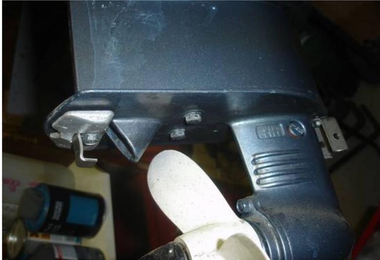
NB : il a fallu entamer un peu l'anode du moteur pour que la ferrure passe correctement.
